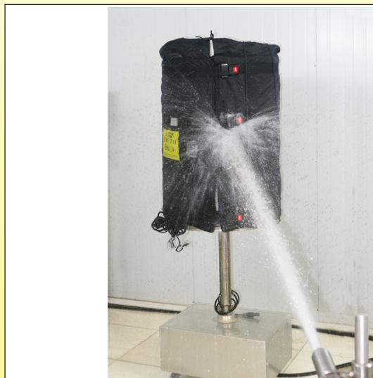
Test IPx6 dei riscaldatori a mantello
