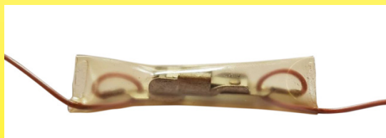
Limitatore di temperatura per coperte Calor a rottura lenta, calibrato a 80°C (1960 circa). Si noti la guaina impermeabile in PVC saldata sui fili e l'anello formato dai conduttori elettrici che passano attraverso un foro in ogni terminale, per eliminare le tensioni di trazione sui fili (Ultimheat Collection).
