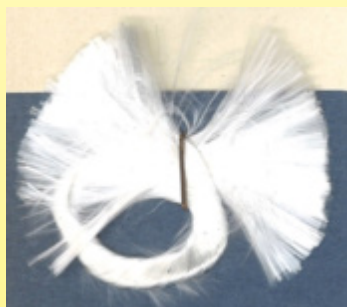
Fasci di filamenti di vetro che formano un unico filo (Fabbricazione di filamenti di vetro, intorno al 1960, lezione della scuola tessile di Verviers in Belgio, Ultimheat Museum)
