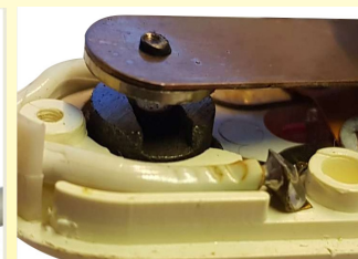
1972 ca. Centralina di controllo della potenza prodotta da Jidé a Limoges con il marchio Jidéstat. Il sistema di maggior successo. Di dimensioni molto ridotte, è regolabile e incorporata nella spina elettrica. È l'unico modello con contatto magnetico a scatto. È stato superato dai sistemi elettromeccanici solo nell'era attuale. (Ultimheat Collection)
